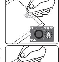
握りを緩めるとSEALINGランプ が消えて超音波の発振が停止 します。作業途中でランプが消 えてしまった場合は、タイマー を長くするか、再度握りなおし てください。
